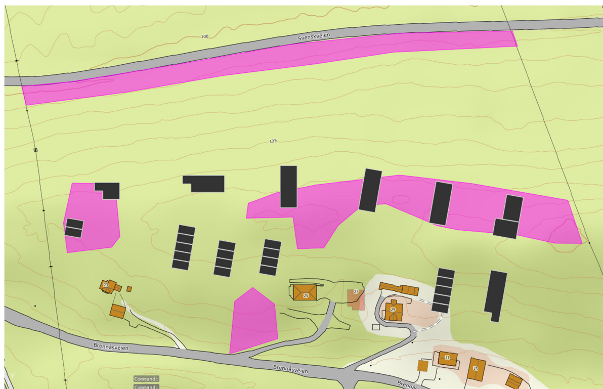
Figur 5-2: oversiktsbilde over planlagt tiltak og områder med berg i dagen. Svart skravur: planlagte bygninger. Lilla skravur: områder med høy densitet med innmålt antatt berg i dagen, og områder der det er observert berg i dagen.
