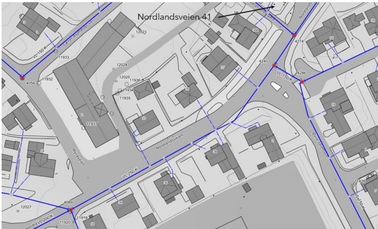
Figur 4: Utsnitt fra kommunens karttjeneste som viser ledningsnett for vannforsyning og brannkummer for uttak av slokkevann, markert med røde sirkler. Kilde: Rana kommune
