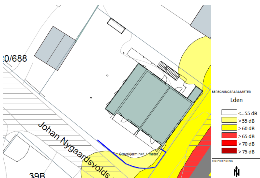
Figur 4 - Beregnet ekvivalent støy, L_{den} , i høyde for utendørs oppholdsareal (1,5 meter over terreng). Blå strek viser planlagt støyskjerm på 1,1 meter mot Nordlandsveien. Utklipp fra vedlagte tegning X005.
