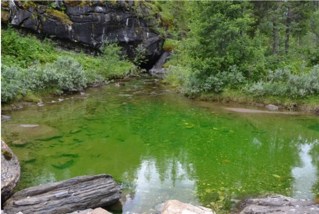
Figur 49. Vann tilsatt fargestoff i forbindelse med tracerforsøk.
