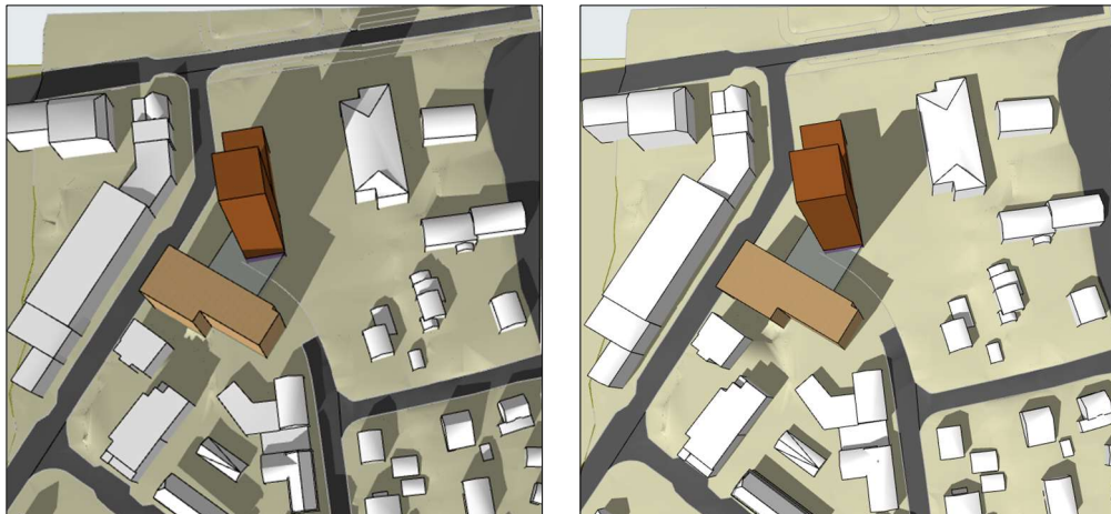
Figur 36 Eksempel på skyggevirkning for en bygning med ca 61 meters høyde, 21.mars og 21.juni kl 15
